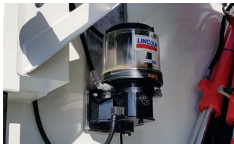
Automatsko podmazivanje kliznih površina
