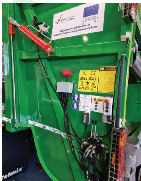
Identifikacijski sustav - RFID i upravljački mehanizam EKOMUNAL nadogradnje
