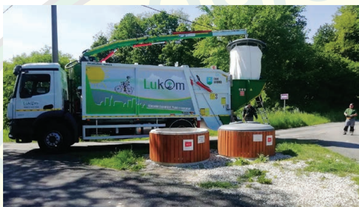
TEHNIX kran u funkciji - podzemni kontejneri
