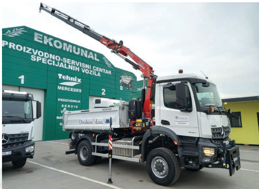
Multifunkcionalni trostrani kiper s kranom na šasiji pogona 4x4 sa zimskom službom
