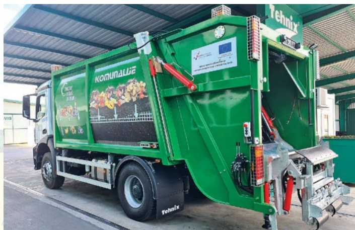
Pocinčani podizač za kante i kontejnere
