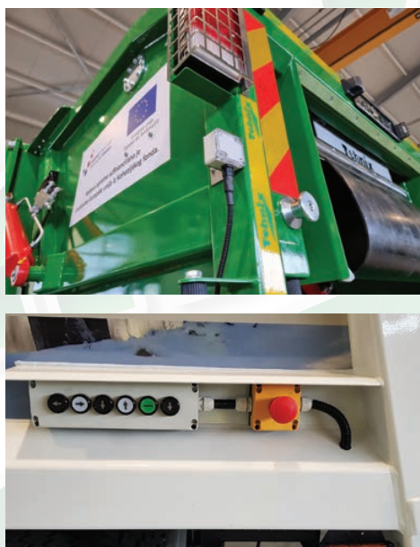
Identifikacijski sustav - RFID i upravljački mehanizam EKOMUNAL nadogradnje
