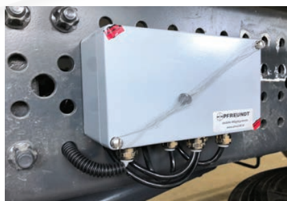
Ugradnja vage na EKOMUNAL vozila
