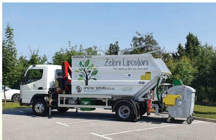
EKOMUNAL 7,5 - podizač za kante i kontejnere te kran u funkciji
