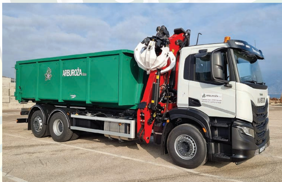
Nadogradnja navlakač abroll-kontejnera s kranom i priključkom za prikolicu
