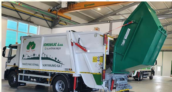
Sustav za pražnjenje komunalnih kontejnera
