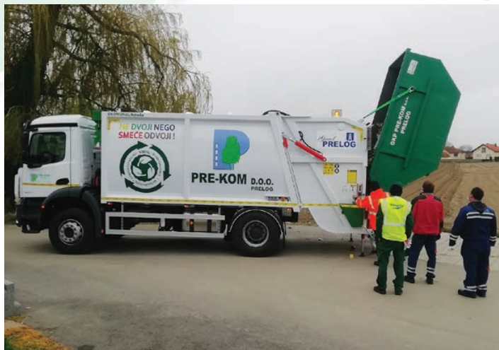
Pražnjenje 5 i 7 m 3 komunalnih kontejnera
