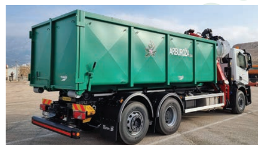
Nadogradnja navlakač abroll-kontejnera s kranom i priključkom za prikolicu
