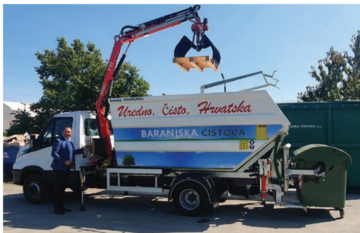
EKOMUNAL 7,5 - podizač za kante i kontejnere te kran u funkciji
