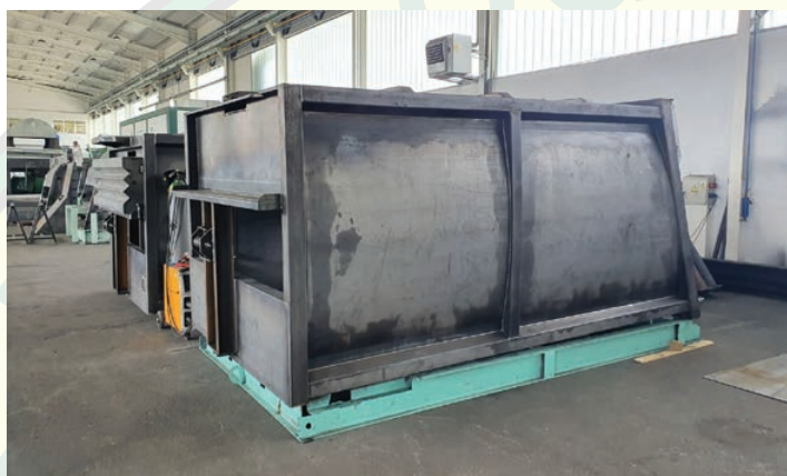
Bazična proizvodnja kostura sanduka nadogradnje
